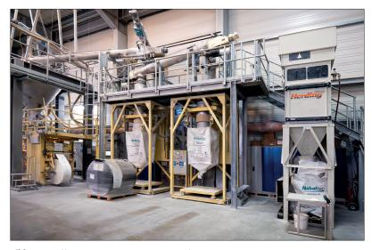
**Bild 1** Hocheffiziente und zuverlässige Staubfiltrationssysteme werden insbesondere im Zuge der Feinstaubdiskussion immer wichtiger (Quelle: Herding Filtertechnik)
